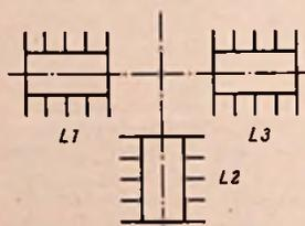
der Spule L 2 und diese senkrecht zur Achse der ersten Spule L 1 liegt und die zweite Spule axial verschiebbar angeordnet ist. Zweckmäßig liegen L 1 und L 3 in einer Achse. Ist L 2 so zwischen L 1 und L 3 geschoben, daß sie mittensymmetrisch zur Achse liegt, so sind alle Kreise praktisch entkoppelt. Eine Restkopplung kann mit Hilfe eines Neutralisations-Kondensators auch noch beseitigt werden. Wird nach der Abstimmung die Spule L 2 aus der Mittellage verschoben, so steigt die Kopplung an.
