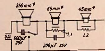
Bild 5. Schaltbild einer Lautsprecherkombination für teilschwingungsfreie Wiedergabe.
