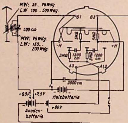
mit Gitterbatterie bzw. Typ WF 4 mit Gitterspannung aus dem Netz ersetzt werden. - Einer der Vorzüge der Dreifachröhre war die feuchtigkeitssichere Unterbringung der seinerzeit wenig stabilen Hochohmwiderstände im Vakuum.
