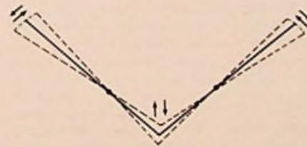
Bild 2. Darstellung des Schwingungsvorganges eines Papierkegels bei der ersten Teilschwingungsfrequenz  $f_1$
