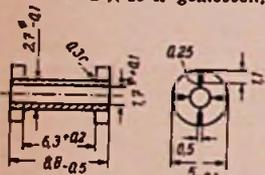
Bild 4. Maße des Rollenkerne (Material Siemens 1S)
