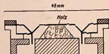
Bild 4. Die Membran des vom Verfasser angefertigten Lautsprechers in Originalgröße. Nach den Berechnungen liegt bei dieser Membran die Teilschwingungsfrequenz  $F_1$  ( $s$ . Text) bei etwa 16 000 Hz
