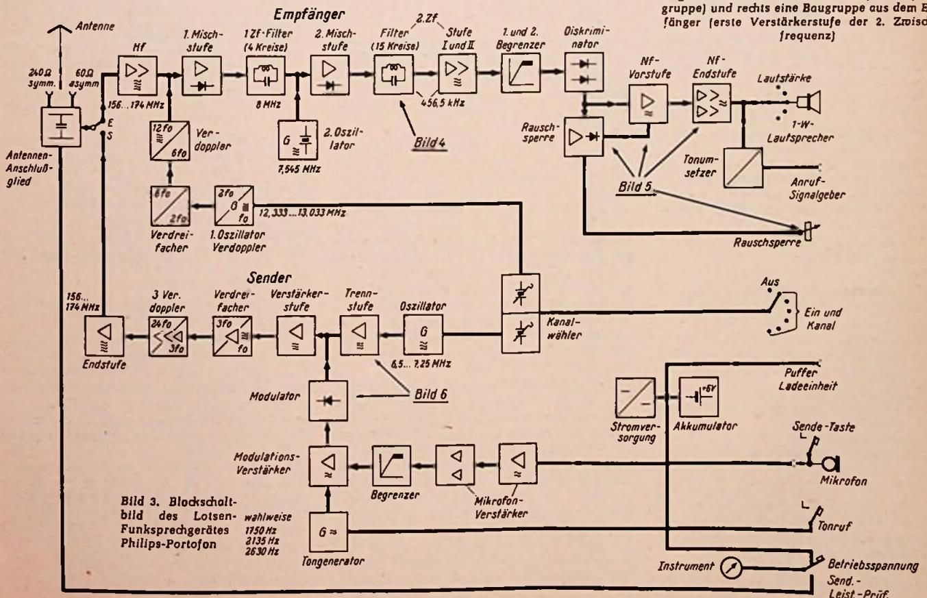
Bild 3. Blockschaltbild des Lotsen-Funksprechgerätes Philips-Portofon
