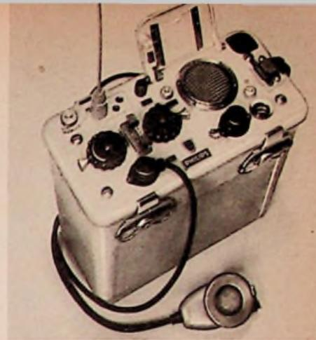
Bild 1. Tragbares Lotsen-Funksprechgerät Philips-„Portofon“ in wasserdichter und schwimmfähiger Ausführung
