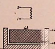
Bild 16. Tiefpaß L3. Spulenkörper: 31 P 120-1 (5); Kernblech: EE 20; Werkstoff: Ferrit Widia C 1; Luftspalt: 0,1 mm
