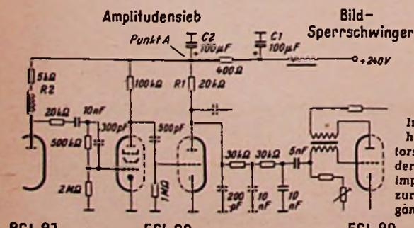
Infolge des schadhafte Kondensators C 2 gelangte der Bild-Synchronimpuls nochmals zurück zum Eingang des Amplitudensiebes
