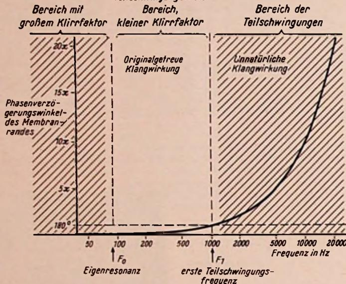
Bild 3. Die Einschwingungsverzögerung des Membranrandes in Phasenwinkeln der jeweiligen Tonfrequenz. Für eine originalgetreue Klangwirkung ist eine Phasenverzögerung von höchstens  $180^\circ$  zulässig (Lautsprecher: Dynamisches System, 180 mm  $\phi$ )
