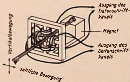
Bild 2. Vereinfacht dargestelltes magnetisches Tonabnehmersystem mit je einem Ausgang für die Tonfrequenz des Seitenschrift- und des Tiefenschriftkanals (London)
