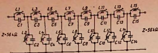
Bild 4. 15-Kreis-Zf-Filter für die zweite Zwischenfrequenz des Empfängers
