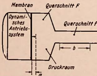
Bild 1. Druckkammer-Prinzip
