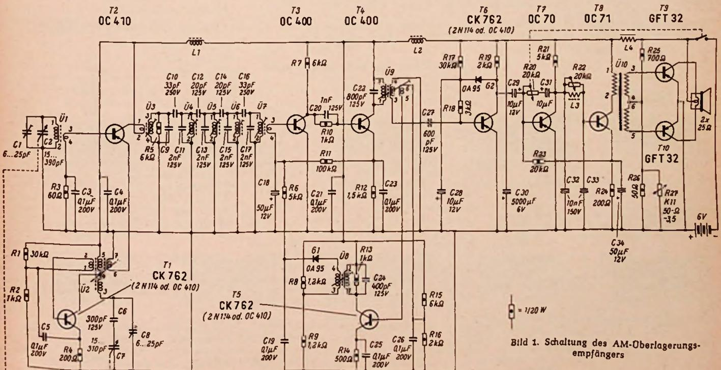
Bild 1. Schaltung des AM-Überlagerungs-Empfängers
