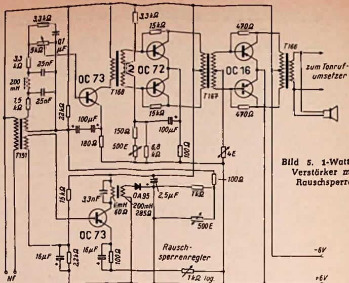
Bild 5. 1-Watt-NF-Verstärker mit Rauschsperrung
