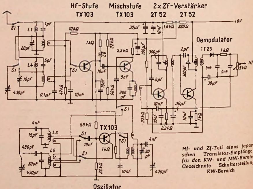
Hf- und Zf-Teil eines japanischen Transistor-Empfängers für den KW- und MW-Bereich. Gezeichnete Schalterstellung: KW-Bereich
