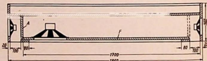
Bild 2. Schnitt durch das Lautsprecherfach (Maße in mm)
