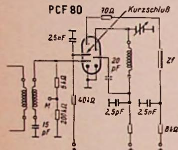
Durch einen im heißen Zustand auftretenden inneren Kurzschluß in der Mischröhre PCF 80 lag an deren Gitter die volle Schirmgitterspannung, wodurch die Kontrastregelung eingeengt wurde
