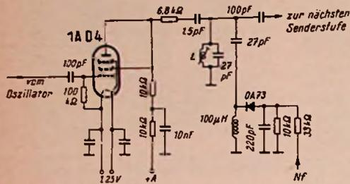
Bild 6. Links Trennstufe zwischen Oszillator und Verstärkerstufe des Senders, rechts Phasenmodulator mit Diode OA 73
