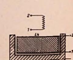
Bild 17. Siebdrossel L4. Spulenkörper: 31 P 120-1 (5); Kernblech: EE 20; Werkstoff: Ferrit Widia C 1; ohne Luftspalt
