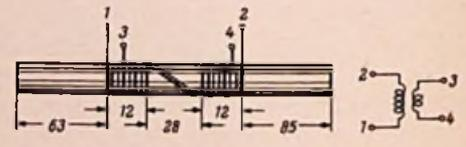
Bild 7. Die Ferritantenne mit den Wicklungen (U1)
