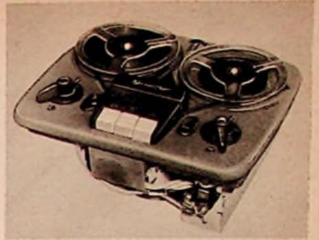
Bild 1. Das TK-5-Chassis fertig zum Einbau
