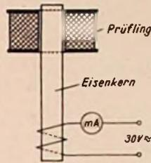
Bild 1. Die Schaltung des Prüfgerätes mit aufgestecktem Prüfling
